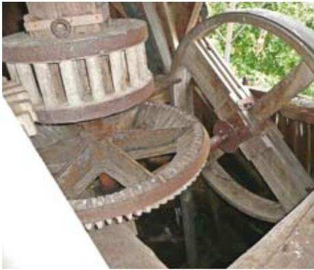
Das Getriebe mit hölzernen und gusseisernen Zahnrädern sowie Riemenscheiben ist vollständig erhalten.
