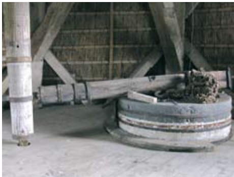
Schrotgang ohne Bütt (rechts) und Spill des Peldegangs (links). Fotos: H. Drost
