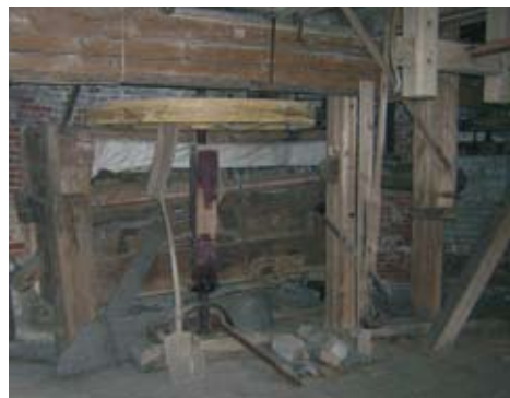
Sechskantsichter und hölzerne Riemenscheibe für den Unterantrieb eines Mahlgangs.
