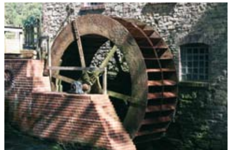
Das mittelschlächtige Wasserrad hat einen Durchmesser von etwa fünf Metern. Fotos: C. Lucht
