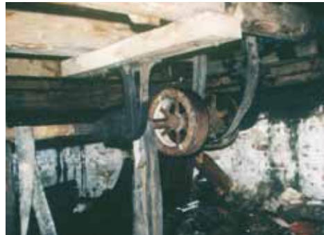
Die Transmissionswelle im Keller der Aseler Paltrockmühle. Aufnahme von 1989. Foto E. Tijman
