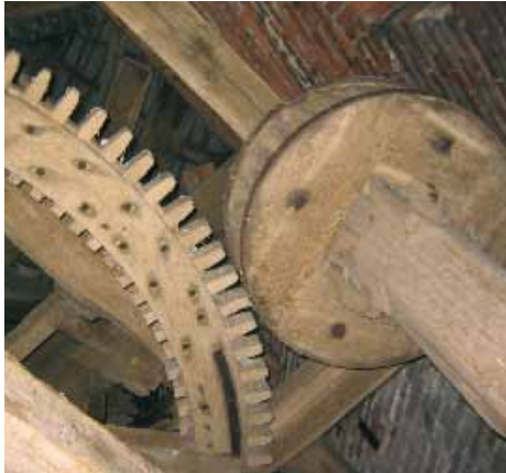
Stirnrad und Korbrad der Schnatmühle in klassischer Holzbauweise. Abbildungen: R. Hagen
