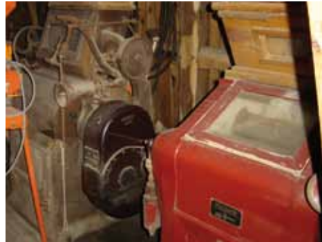
Walzenstühle im 1. Stock der Paltrockmühle Rodewald. Foto: E. Tijman
