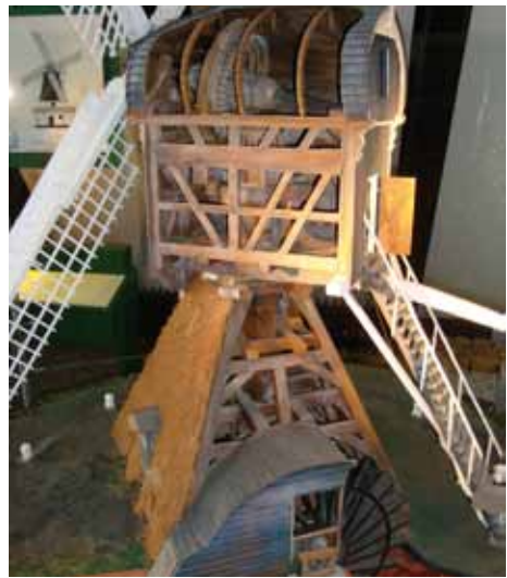
Maßstabsgerechtes Funktionsmodell einer niederländischen Wasserschöpfungsmühle.
