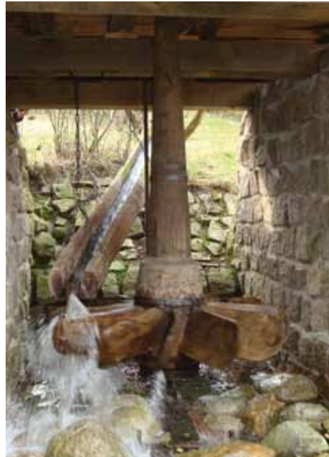
Löffelrad-Antrieb der über 100 Jahre alten Wassermühle aus Serbien.
