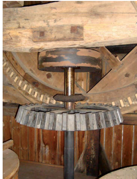
Hölzernes Kammrad und gusseiserner Bunkler mit gusseiserner Königswelle in der Liebenburger Mühle. Foto: Ph. Oppermann
