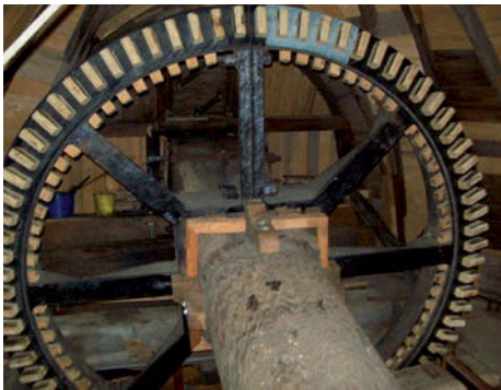
Gusseisernes Kammrad in der Mühlenkappe.
