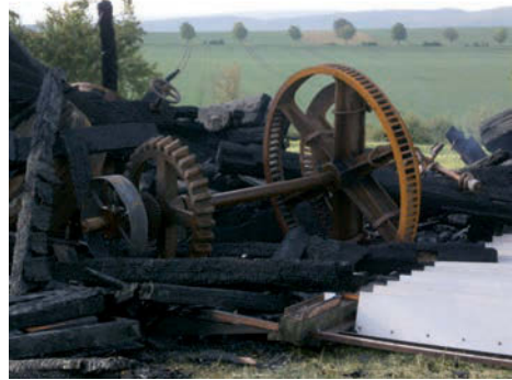
Ausgeglühte gusseiserne Antriebswellen und Räder inmitten der Ruine. Fotos: R. Hagen
