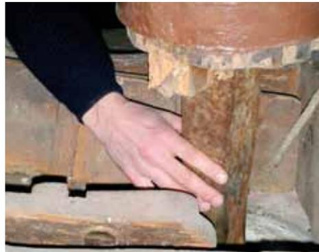
Bild 13, Quetschgefahr am Rüttelschuh.
