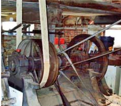
Bild 15, Antrieb für ein Sägegatter mit Treibriemen.
