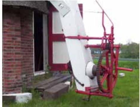
Mit der Stertwinde wird die Mühle auf den Wind gesetzt
