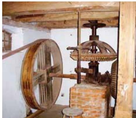
Bild 14, Mahlgangantrieb mit offenem Treibriemen.
