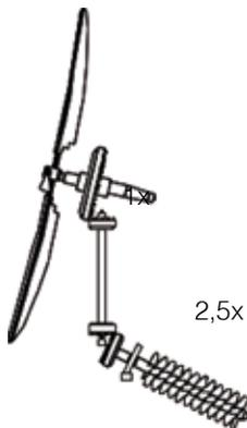
Kammradantrieb, wenn die Flügel einmal rund gehen dreht die Schraube ungefähr 2,5 mal rund.
