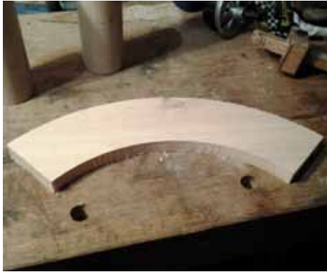
Schablone für eine Scheibe D=600mm
