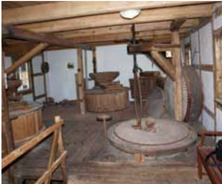
Die drei Mahlgänge in der Mühle, einer ist mit Motor betriebsfähig.
