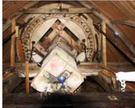
Flügelachse, Pennlager, Kammrag mit Fang.
