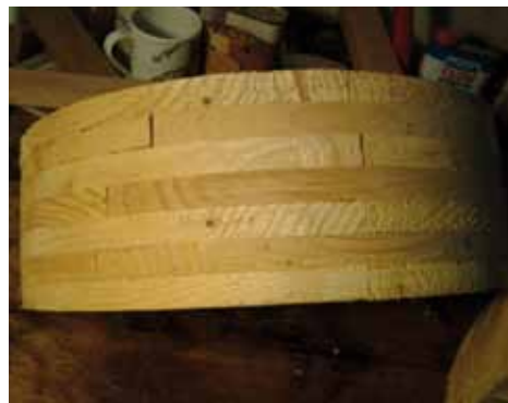
Die Lagen überlappen sich um ca. die Hälfte der Lage eines Segments.
