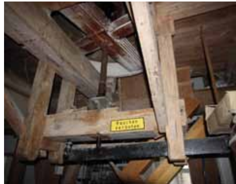
Brüggbalk, Mühlleisen, Spoonpott.
