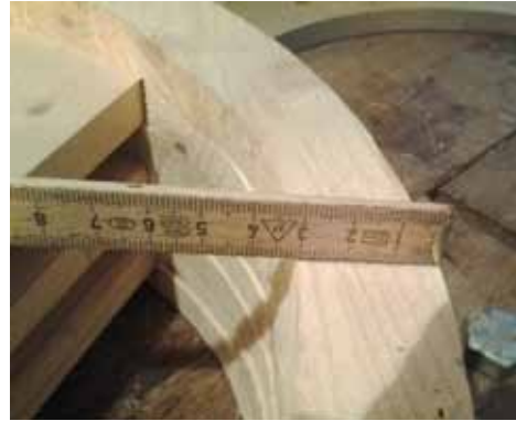
Felge für eine Scheibe zum Antrieb eines Elevators.
