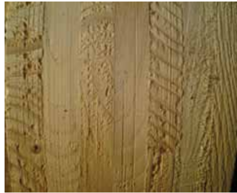
Roh fertiggedrehte Scheibe. Das Holz wird am Schluss noch mit Schleifpapier geglättet.
