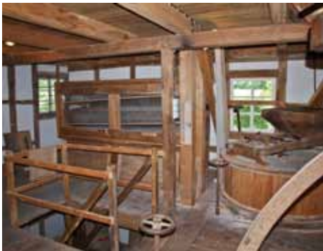
Sechskanter, Speisung vom Mahlgang über einen Elevator.
