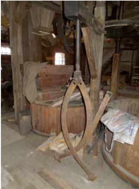
Der Steinkran auf dem Mahlboden.
