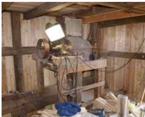
Der Quetschstuhl mit Unterbau hat auch die Reise von Roitzsch nach Schkortitz gemacht und ist in der Mühle wieder eingebaut worden. Fotos: R. Wessel
