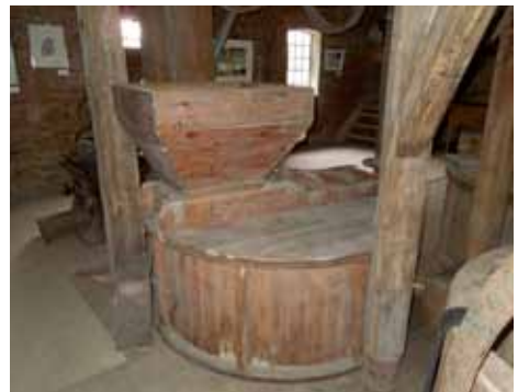
Von den drei Mahlgängen ist einer komplett erhalten.
