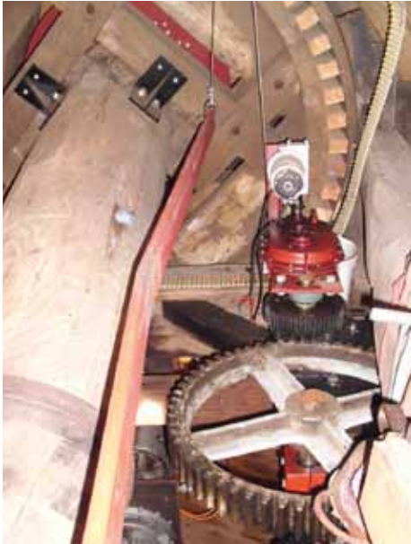
Elektromotor und Zahnrad neben Flügelwelle von oben herunter fotografiert.
