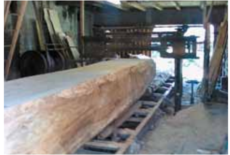
Einschnitt einer Eiche mit einem Inhalt von 5fm. Der Stamm wurde vorher mit einer Motorsäge besäumt damit er durch das Gatter passt.
