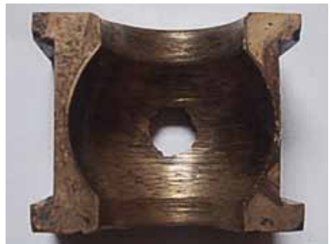
Völlig ausgeschlagene Messinghalbschale des Pleuelstangenlagers am Gatterrahmen.
