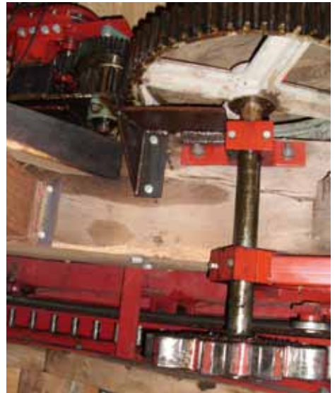
Letzte Übersetzungsstufe mit Zahnrad auf Zahnkranz der Kappe (Unterring).
