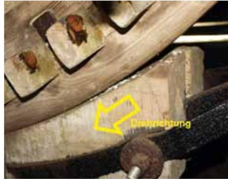
**Bild 5:** Bremse (Säbelstück)
