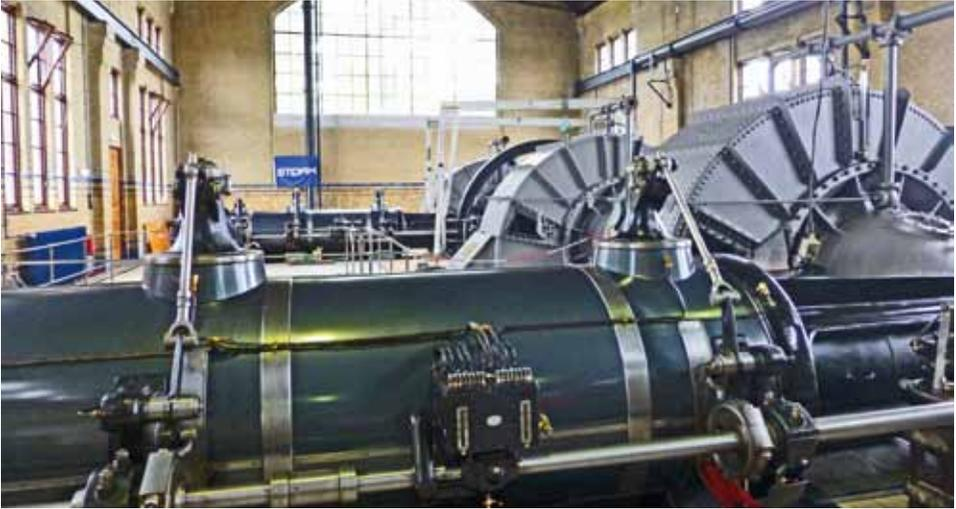
Schöpfwerk-Hallenübersicht mit Dampfmaschinen und Pumpen.
