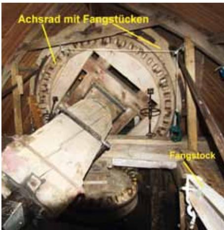
**Bild 3:** Flügelachse mit Achsrad und Fang.
