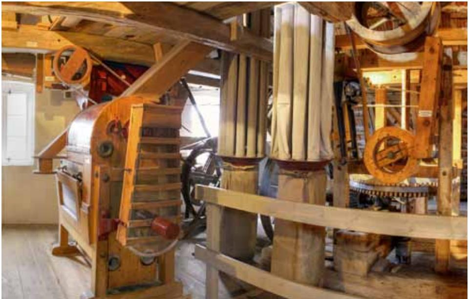
Trier, Schälmaschine, Filterschläuche und Antrieb für den Sackaufzug.
