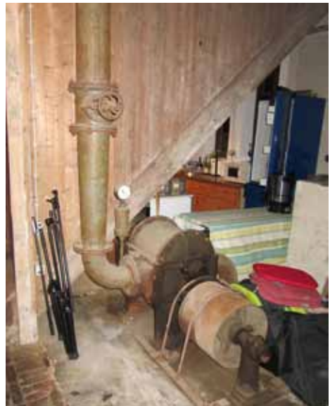
Der Saugheber kurz nach seiner Inbetriebnahme. Deutlich erkennbar die lange Rohrleitung zur Mühle.
