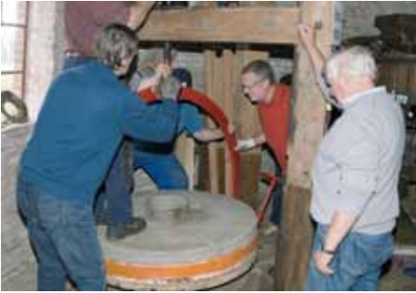
Mit einer Art Zange hoben die Müller in der Leezdorfer Mühle den oberen Mühlstein vom unteren.
