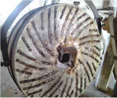
Die Luftfurchen am Läufer, diese sind aus Gummi, mit Stahlblech abgedeckt.
