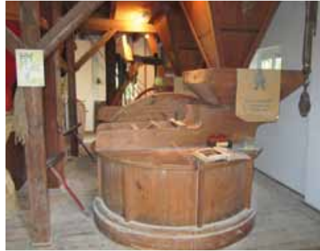
Das Herzstück - die beiden Mahlgänge der Mühlenanlage.
