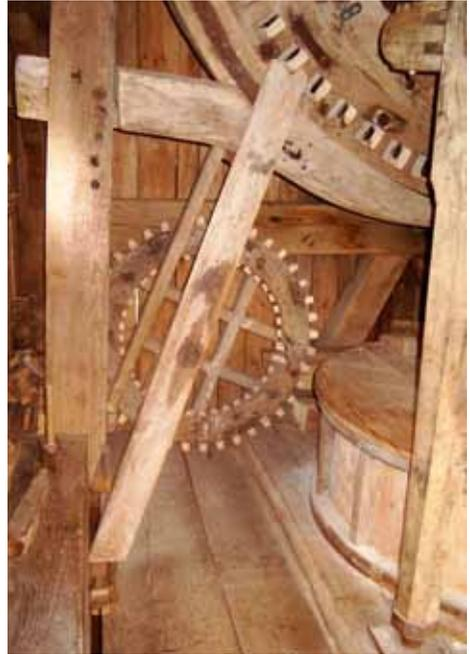
Gegen Rückwärtsdrehen ins Kammrad eingestellte Sturmstütze in der Bockwindmühle Dudensen.
