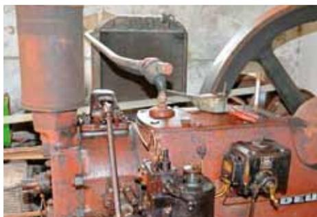
45 PS leistet der liegende Einzylinder von Deutz aus dem Jahre 1929. Er diente bei Wassermangel als Hilfsantrieb der Mühle.
