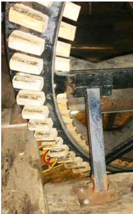
Gegen Rückwärtsdrehen in die Speiche des gusseisernen Kamrades geklappte Sturmstütze in der Holländermühle Steinhude. Fotos: R. Hagen
