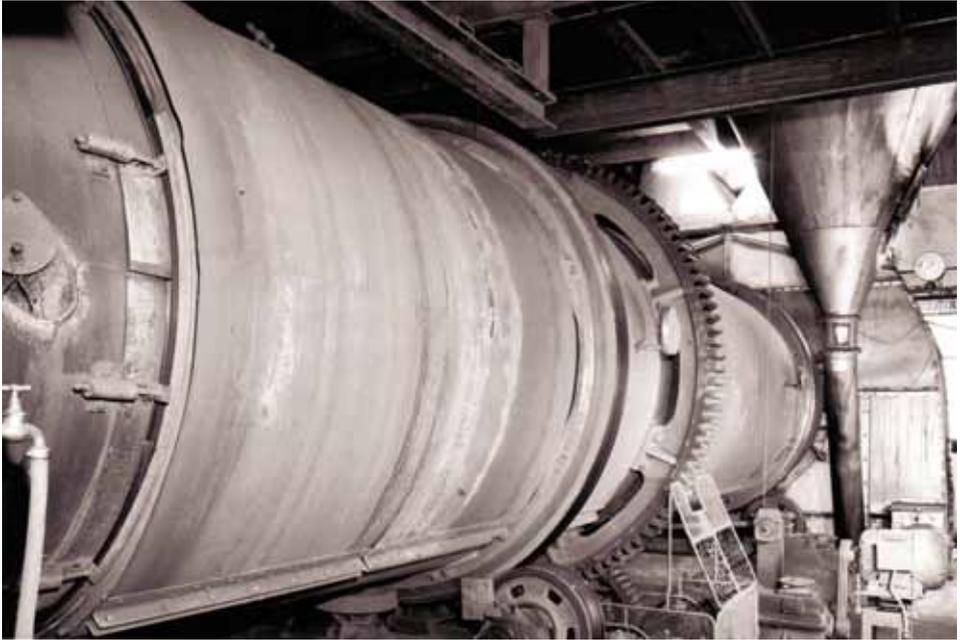
Trommeltrockner der RWG. Deutlich sind der Antrieb und die Leitrollen zu erkennen.
