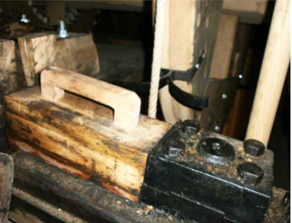
So genannter Klappenknecht oder Wächter gegen Zuschlagen der Jalousieklappen bei plötzlichem Rückenwind in der Bockwindmühle Wettmar.
