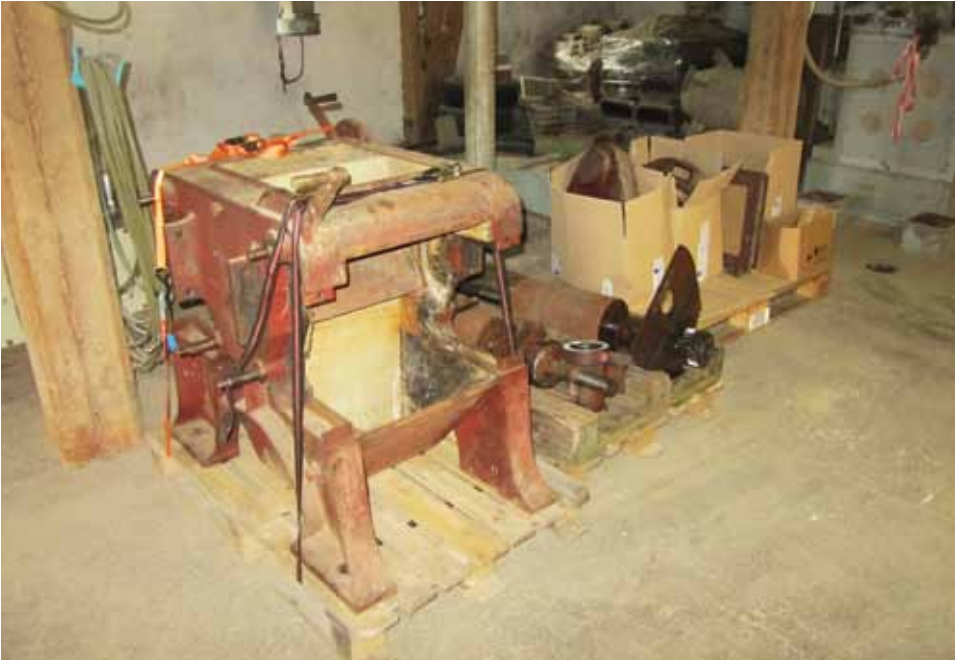
Ein sehr alter Bühler - Doppelwalzenstuhl mit sämtlichen Zubehör.
