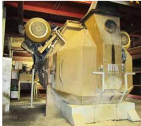
Eine der drei Pelletpressen zur Herstellung von Presslingen.
