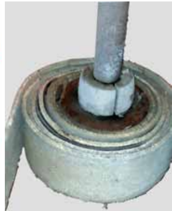
Links: Fahrkorb-Rollen und -Achsen. Zwei Achsen sind stark verschlissen und hätten nicht viel länger durchgehalten. Rechts: Traggurttwickel.
