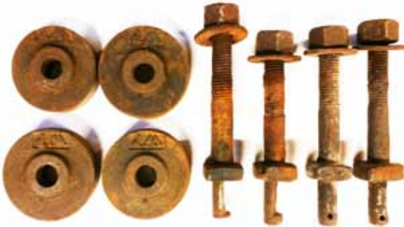
Links: Fahrkorb-Rollen und -Achsen. Zwei Achsen sind stark verschlissen und hätten nicht viel länger durchgehalten. Rechts: Traggurttwickel.
