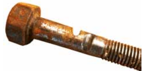
Die etwas andere Art, Stahl zu sägen: Von der Rolle abgelaufenes Stahlseil hat die Achse halb durchtrennt.
