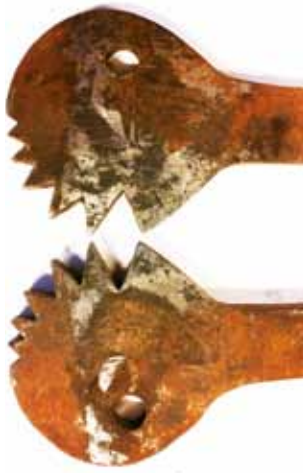
Links: Der Zahn der Zeit und Würmer haben genagt: Reste vom Fahrkorb. Mitte: Zahnklauen nach Ausbau. Rechts: Reibräder des Fahrstuhlantriebes.
