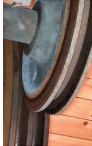
Links: Der Zahn der Zeit und Würmer haben genagt: Reste vom Fahrkorb. Mitte: Zahnklauen nach Ausbau. Rechts: Reibräder des Fahrstuhlantriebes.
