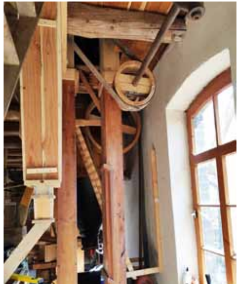
Motor, Riemenscheiben und Sichterantrieb unter der Decke.
