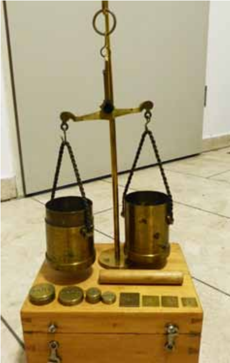
Vormetrische gleichschenkelige Kornwaage (ca. 1850).
