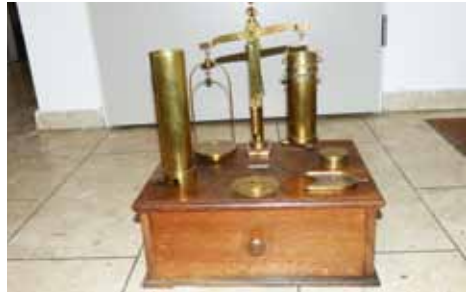
Metrische Kornwaage (¼ltr. Getreideprober), von Louis Schopper, Leipzig, ab 1892.
