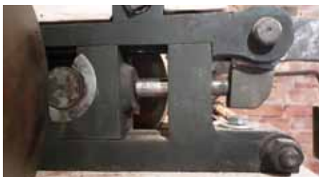
Bild 4 und 5: Beeindruckend einfache und effiziente Konstruktion zur Erzeugung des Quetschdrucks: Mittels Hebelwirkung von 1:14 erzeugen die 18 kg-Gewichte je nach Stellung auf dem Gewichtsarm einen Druck von bis zu 250 kg, der über den Druckbolzen und den Lagerschlitten auf die Schleppwalze und damit auf das zu quetschende Getreide wirkt.
