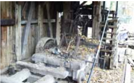
Blick in die Sägerei auf Transport- und Klemmwagen, hinten die Säge, 6 Sägeblätter sind vom letzten Schnitt noch eingespant.
