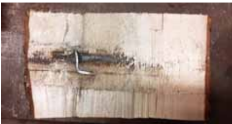
Ein Nagel im Stamm, der Schnitt läuft weg, Säge anhalten, Stamm zurückfahren, Blatt ausbauen, weitersägen, wenn noch etwas Brauchbares übrig bleibt. Originalton: „Dammich nochmöl! Wat hebtst se allwedder to'n sägen bröcht? Fofftein deit nu utfallen!“
