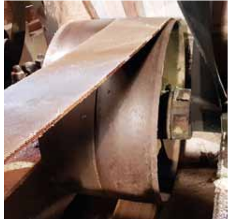
Kupplungstechnik des 19. Jahrhunderts: Eine Rollengabel (unten, hier nicht sichtbar) verschiebt den laufenden Riemen zwischen Lose- (Leerlauf-) und Festscheibe und lässt die Säge anlaufen oder anhalten.
