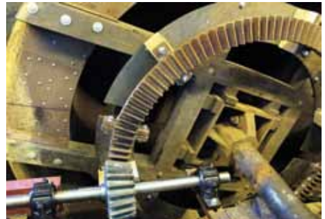
Original-Zahnkranz am Wasserrad ist wieder angebaut, Ritzel und 33 m-Welle zur Sägerei sind erneuert.
