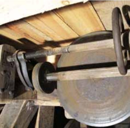
Die Position des Antriebsrades auf dem Friktionsteller wird per Handrad (rechts oben) verstellt und ändert die Vorschubgeschwindigkeit um Faktor 2. Zu hohe Last bewirkt Durchrutschen der Friktion.
