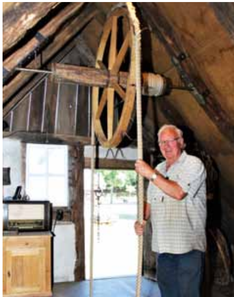
Heinz Pöpping erklärt Bau und Funktion des Gaffelrades: Ein endlos gefertigtes Tau läuft über ein Rad, wobei eiserne Gaffeln es führen und halten.
