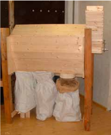
Abb. 10: Sechskant-Trommelsichter für die Larreller Windmühle „Kost Winning“.
