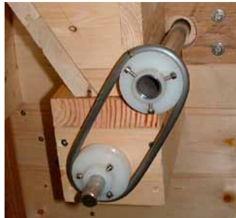
Abb. 8: Riemenantrieb zwischen Sichterachse und Transportschnecke.
