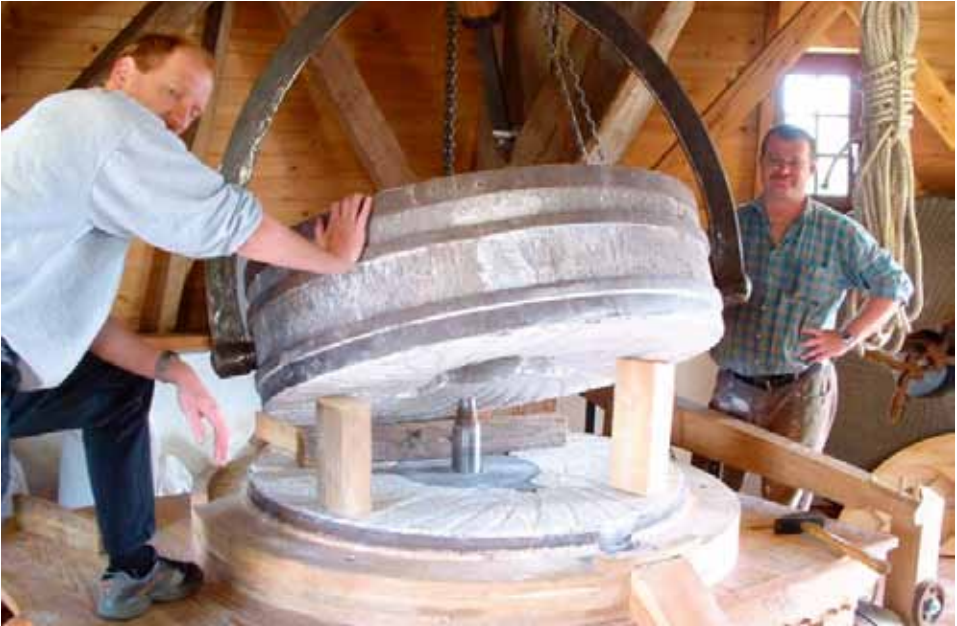
Abb. 2: Mahlgang der Larrelter Windmühle. Mahlsteindurchmesser: 1,2 m. Gewicht pro Stein: 450kg.
