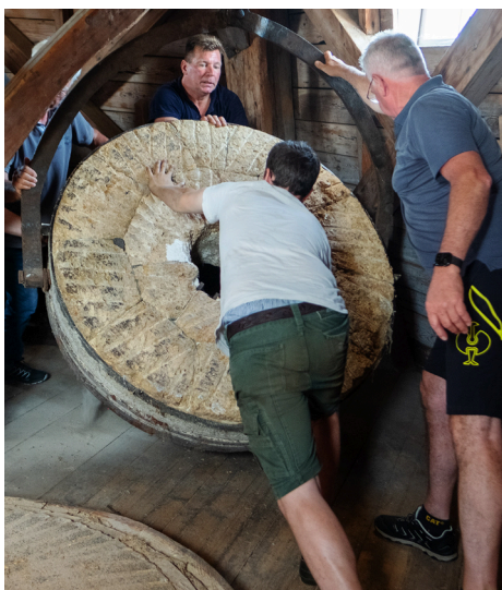
Der Mühlstein in der Windmühle „de Griese Graue“ in Lübburstedt wird angehoben, um das Steinlager zu fetten.
